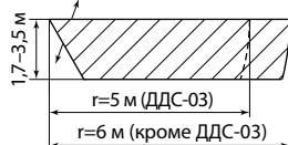
ДДС Зона обнаружения по вертикали (вид сбоку)
