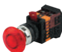
Б0045630 Кнопка АЕЛА22 "Грибок" Ø22мм 240В 1з+1р Цвет: Красный Подсветка: Неон
